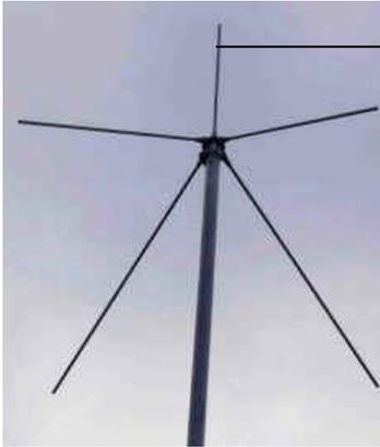
2. Antennenstab „A“ Dipol am Antennenkopf befestigen.
