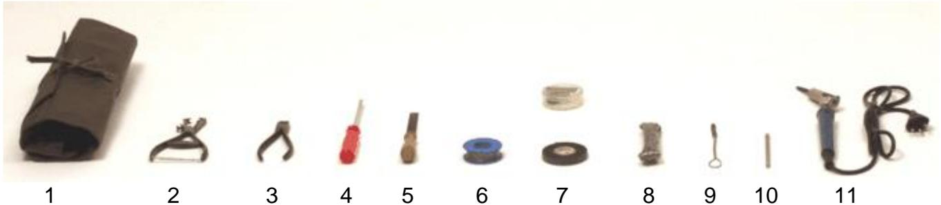
Abbildung: Reparaturetui für Feldkabel mit Material und Werkzeug
