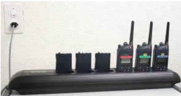
Mittels Mehrfachladegerät können maximal 6 Handfunkgeräte oder Akkus gleichzeitig aufgeladen werden.
