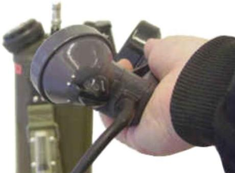
1. Zu prüfende Sprechgarnitur an kontrolliertem, betriebsbereitem Gerät anschliessen.
