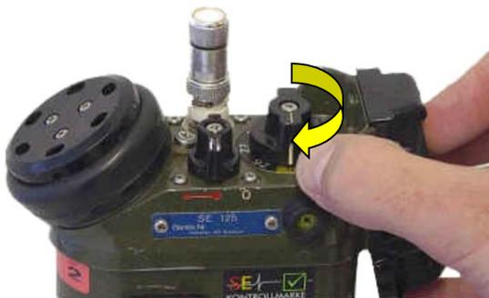
5. Kanäle 1 – 8 einstellen und bei jedem Kanal Sprechaste kurz drücken.
