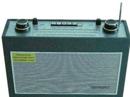
Sofern noch Radioempfänger E-606 vorhanden sind, können diese mit deren Zubehör an die Antennenanschlussdosen angeschlossen werden. Der Radioempfang kann auch mittels Langdrahtantenne, die im Freien ausgelegt wird, sichergestellt werden (siehe Seite 69).
